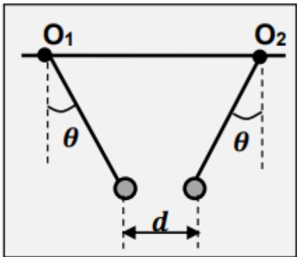
En faisant varier à chaque fois la distance  $d$  entre les deux sphères (en modifiant les positions  $O_1$  et  $O_2$ ), les élèves mesurent l'angle  $\theta$  que font chacun des pendules avec la verticale. Les résultats obtenus sont consignés dans le tableau suivant :
